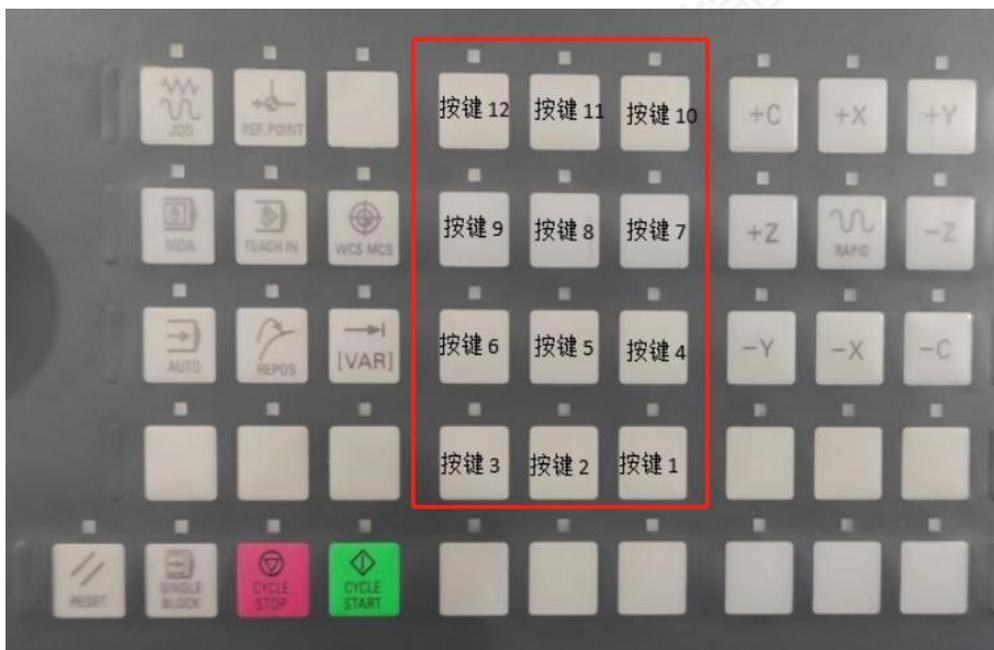
图 B-1 按钮、指示灯定义图
