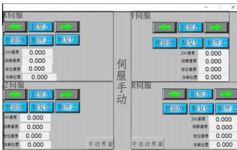
图6 轴系控制界面调用示意图
