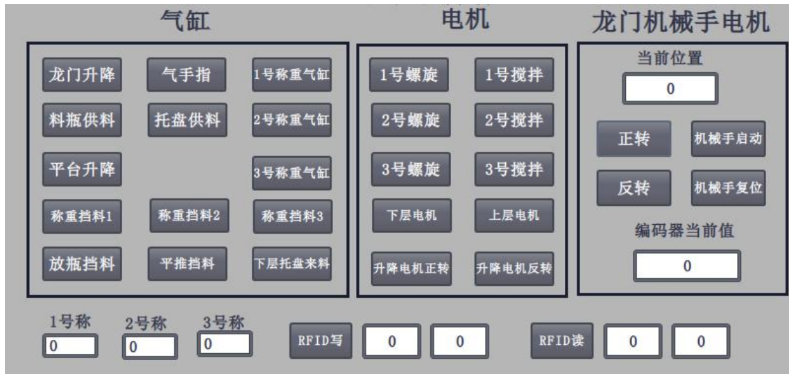
图 2-2 供料灌装站手动操作页面
