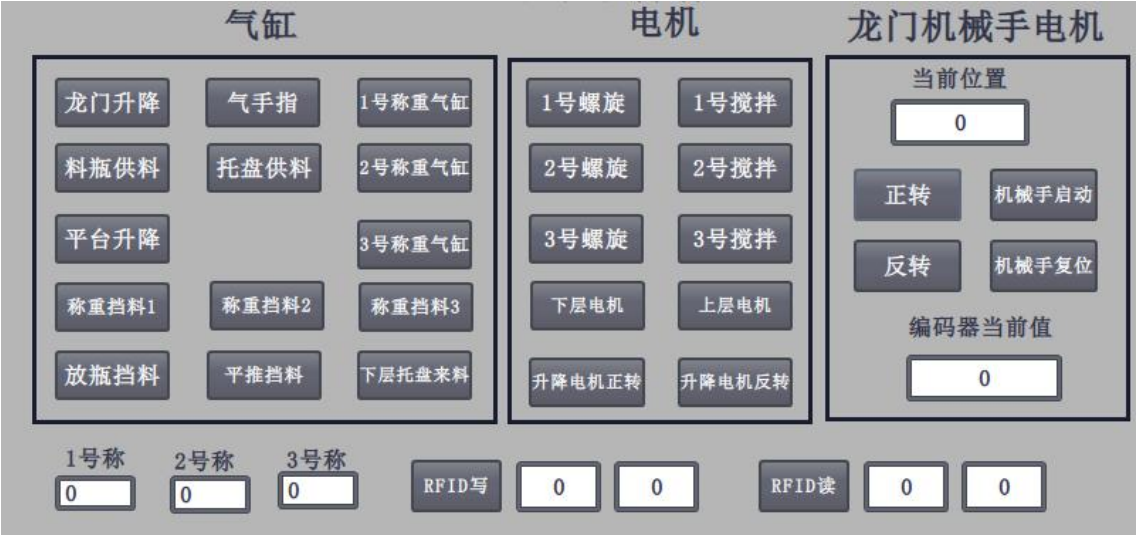
图 2-2 供料灌装站手动操作页面
