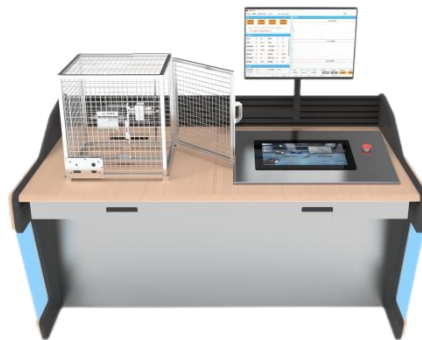
无人机动力系统选型测试工位效果图
