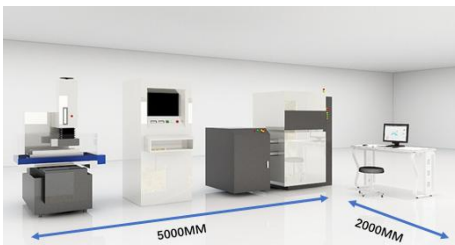
图 2 金属 3D 打印工位布局图
