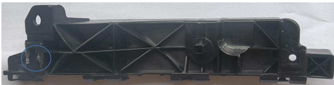
图 3 受损后汽车前杠支架
